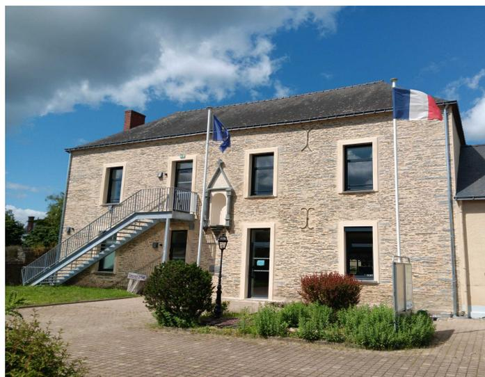
Sur la façade avant de la bâtisse, les murs ont été piquetés de façon à faire ressortir les pierres, les ouvertures changées et un escalier extérieur ajouté permettant un accès autonome à la salle de réunion.
